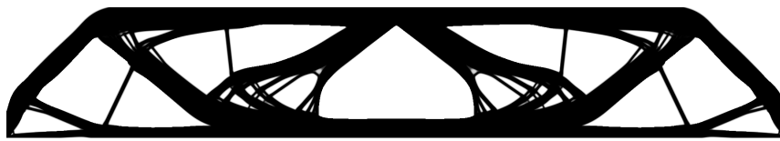
FIGURE 1 – Exemple d'optimisation topologique d'une poutre en flexion.
