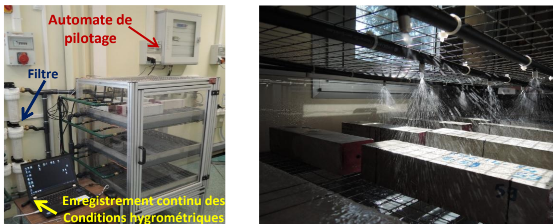
Figure 3. Le dispositif ARIEL ( simulAting RaInfall for concrEte durabiLity ) pour corrosion accélérée par cycles de pluie en laboratoire
