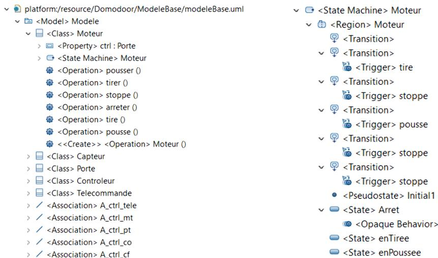
FIGURE 9 – Représentation UML des classes et d’un diagramme états-transitions
