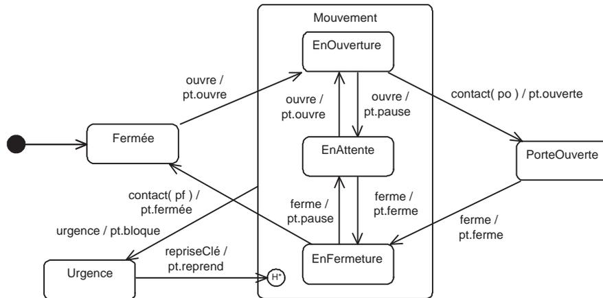
FIGURE 3 – Diagramme Etats-transitions du contrôleur - porte de garage
