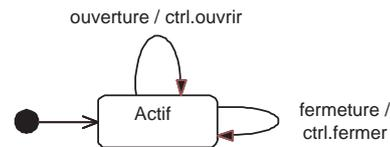
FIGURE 4 – Diagramme Etats-transitions de la télécommande - porte de garage
