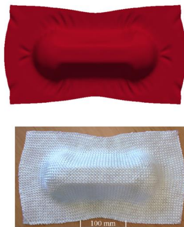
Fig.7. Simulation de l'emboutissage de monocouche sur géométrie double-dôme
