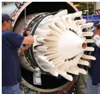
Fig. 1 - Pièce sortie moteur en CMC Oxyde-Oxyde GE
