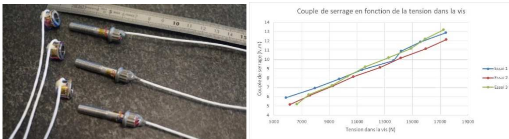
Fig. 11. a) Vis instrumentées et b) Etalonnage associé
