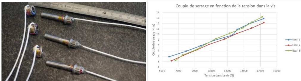
Fig. 11. a) Vis instrumentées et b) Etalonnage associé
