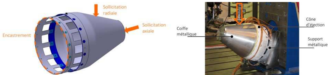
Fig 15. Essai échelle 1 sur structure
