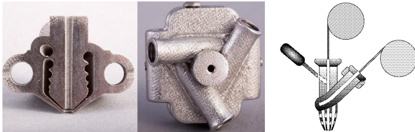
Figure 5 : Aperçus du système d'imprégnation d'Orbital Composites au travers une buse alimentée par un filament polymère et un filament de fibre continu [8]
