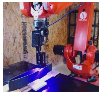
Figure 4 : A gauche d'imprimante Markforged Mark X7 et à droite la tête de dépose de filament CC3D avec liant photo-réticulable.
