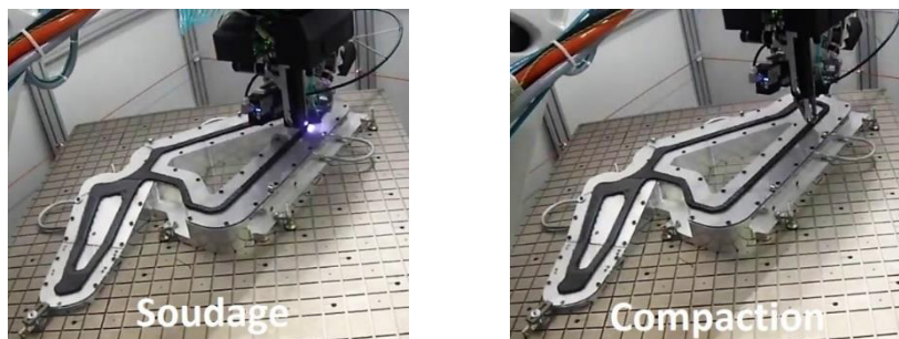
Figure 8 : Exemple d'application du procédé AREVO dans la confection d'un cadre de vélo en composite fibre de carbone, avec à gauche l'étape de soudage laser des différentes couches et à droite l'étape de compaction[17].
