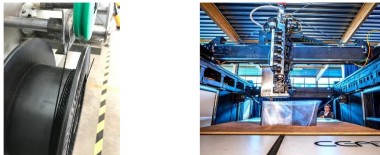
Figure 7: A gauche une bobine de fibre de carbone continue imprégnée de résine thermoplastique et à droite la cellule CFAM de CEAD.
