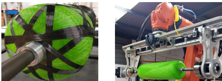
Figure 9: Robot KUKA équipé du matériel MFTech permettant l'enroulement filamentaire de tapes
