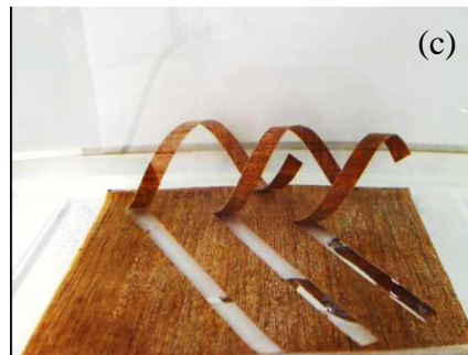
Fig 5 Résultats issus d'une simulation numérique d'un biocomposite hygromorphe avec une orientation [0,90^\circ]_s (a) et [\pm 45^\circ]_s (b). Résultats expérimentaux de découpes à 45^\circ (kirigami) d'une plaque de biocomposite hygromorphe.
