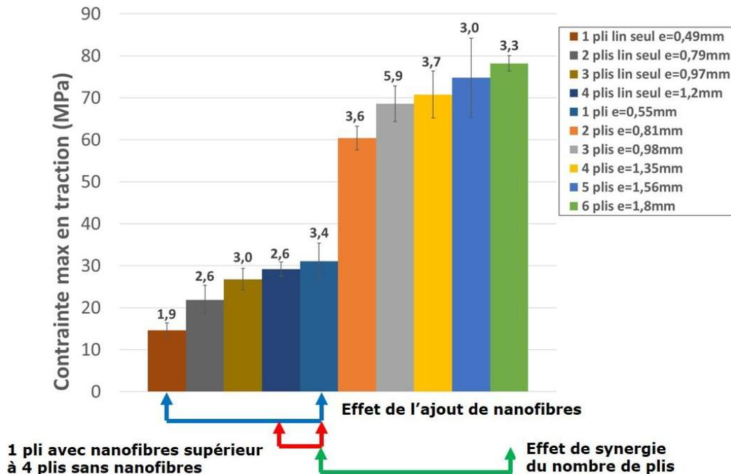
Fig. 6. Contrainte maximale en traction en fonction du nombre de plis de lin constituant la préforme, imprégnés ou non. Le module d'Young de chaque renfort est donné en étiquette.
