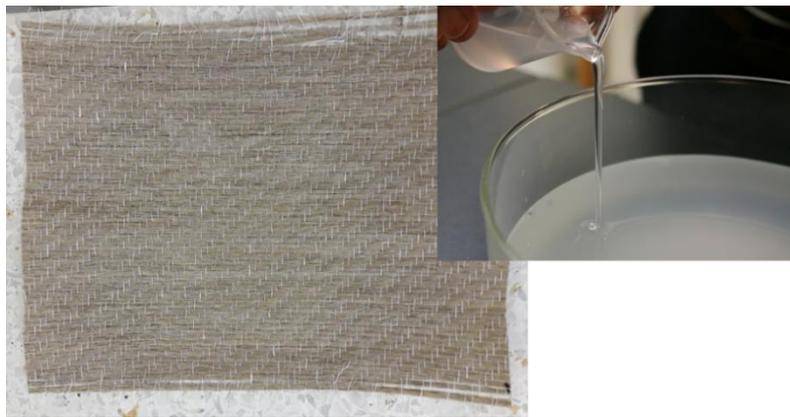
Fig. 1. Renfort UD et solution de nanocellulose.
