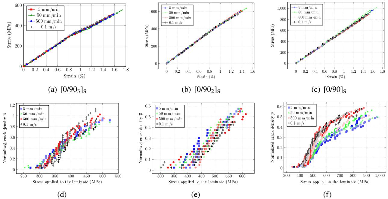
Fig. 3. Comportement macroscopique à différentes vitesses pour différentes configurations de stratifié  $[0/90_n]_S$  (en haut) et évolution de la densité de fissuration transverse en fonction de la contrainte appliquée à différentes vitesses (en bas)
