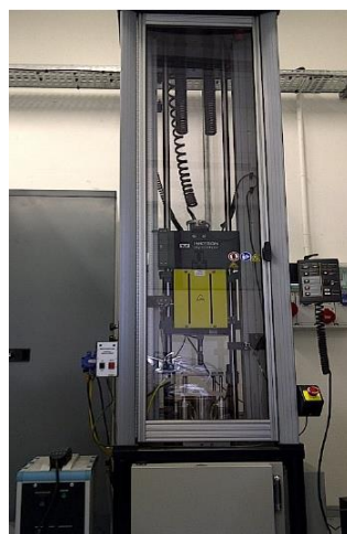
Fig. 2. Machine d'impact (Instron Dynatup 9250HV).
