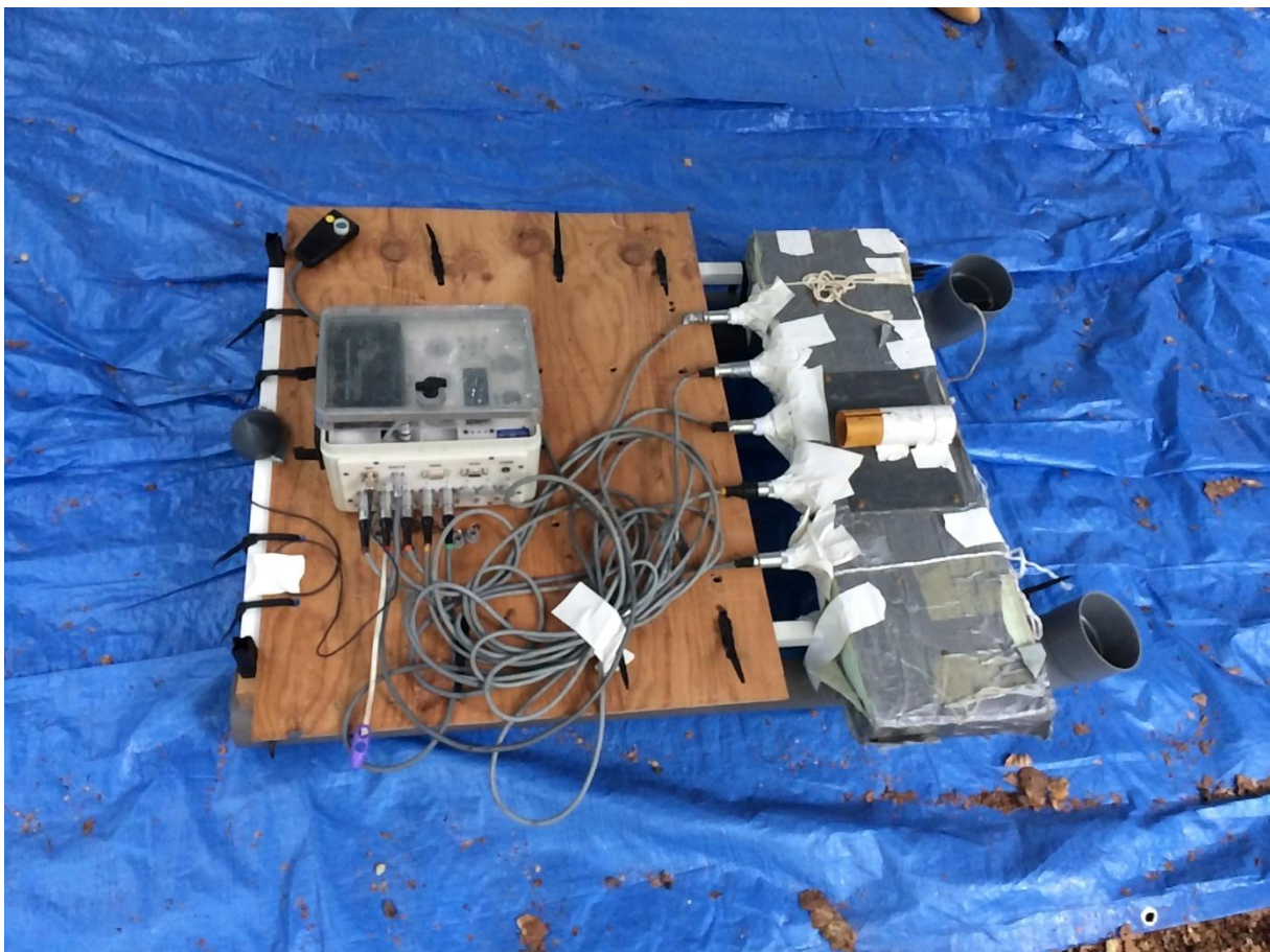
Figure 1 : Dispositif à capteurs portés développé par l'IPGS.
