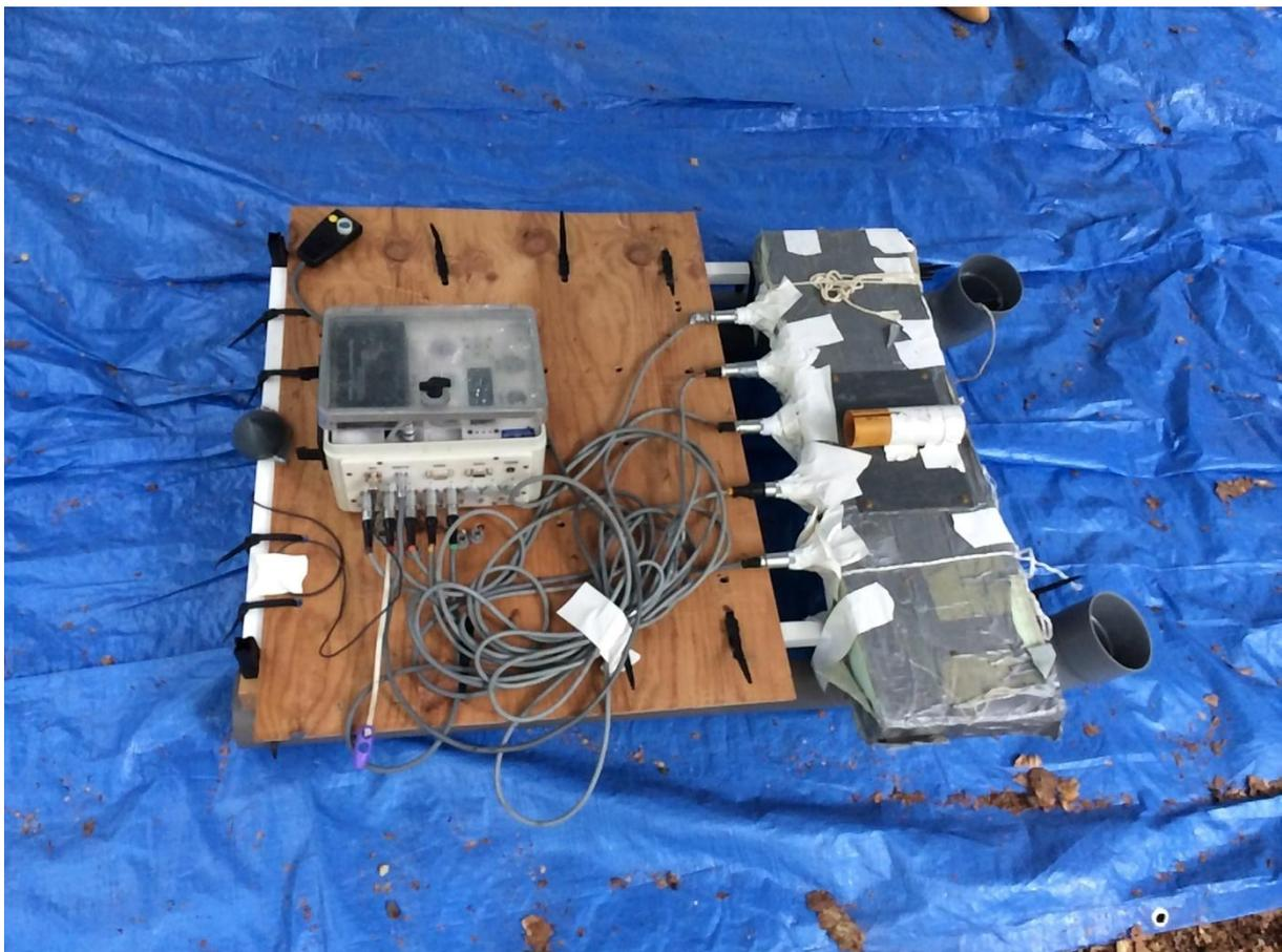
Figure 1 : Dispositif à capteurs portés développé par l'IPGS.
