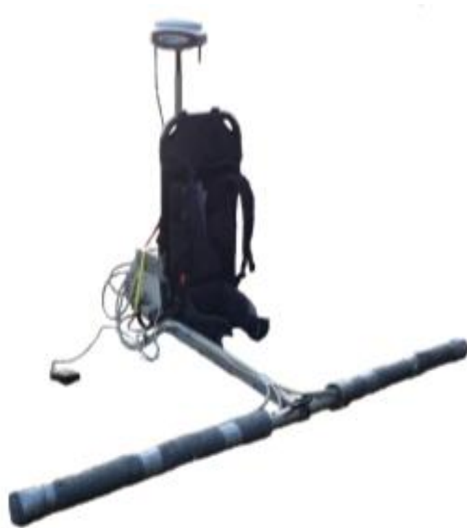
Figure 1 : Dispositif à capteurs portés développé par l'IPGS.
