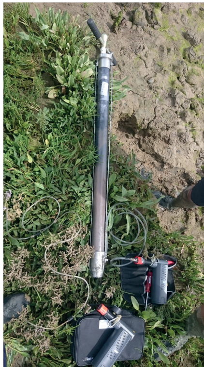
Photos 2, 3 et 4 - Carottage au « Beeker » en arrière de cordon dunaire et à distance des chenaux
