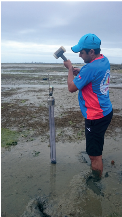
Photos 2, 3 et 4 - Carottage au « Beeker » en arrière de cordon dunaire et à distance des chenaux
