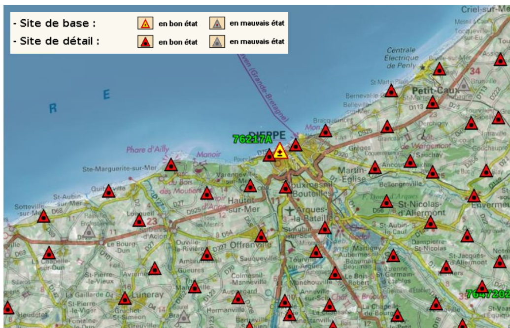
Figure 5 - Points du réseau géodésique de l'IGN sur le site de Seine-Maritime (geodesie.ign.fr)
