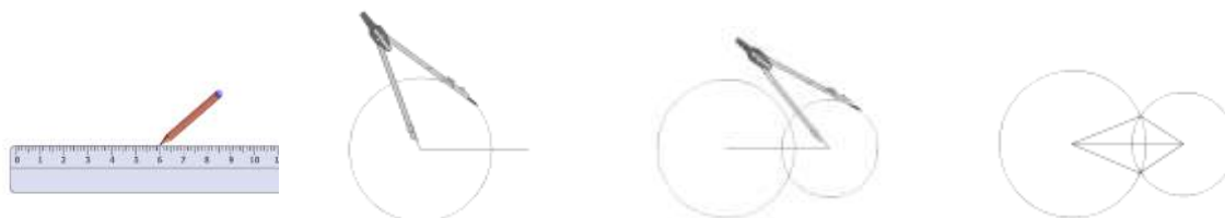
Figure 1 : Illustration de la construction du triangle à la règle et au compas.
