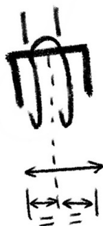
Figure 4 : Installation d'un tapis « au milieu » d'une élingue
