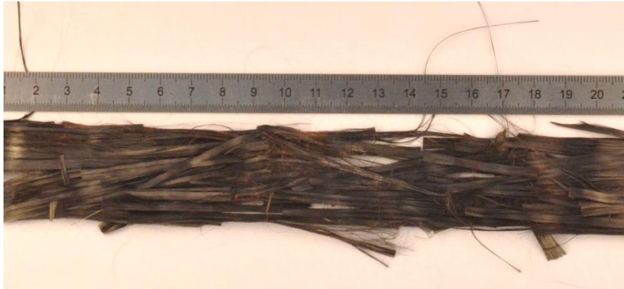
Fig. 1. Préforme quasi unidirectionnelle constituée de fibres discontinues
