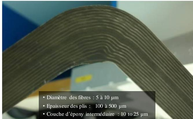
Fig. 1. Configuration cible d'une structure composite courbe formée d'empilement de plis à polymère renforcé de fibres de carbone (PRFC).
