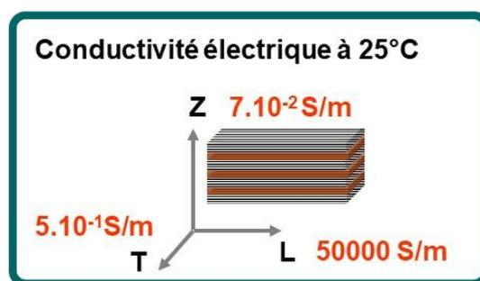
Fig. 2 Niveaux de conductivité électrique (en  $S.m^{-1}$ ) d'un stratifié unidirectionnel carbone/époxy [ $0^{\circ}_s$ ] avec  $V_f = 60\%$  (produit par RTM). Mesures sous courant continu à température ambiante [1].
