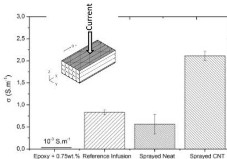
Fig. 5. Conductivité électrique sens Z épaisseur (ou  $\sigma_z$ ) d'un stratifié carbone/époxy [0°] produit en infusion (reference infusion) ou par spray (sprayed neat) ou toujours par spray (sprayed NTC) mais avec 0,75wt% de NTC [4].
