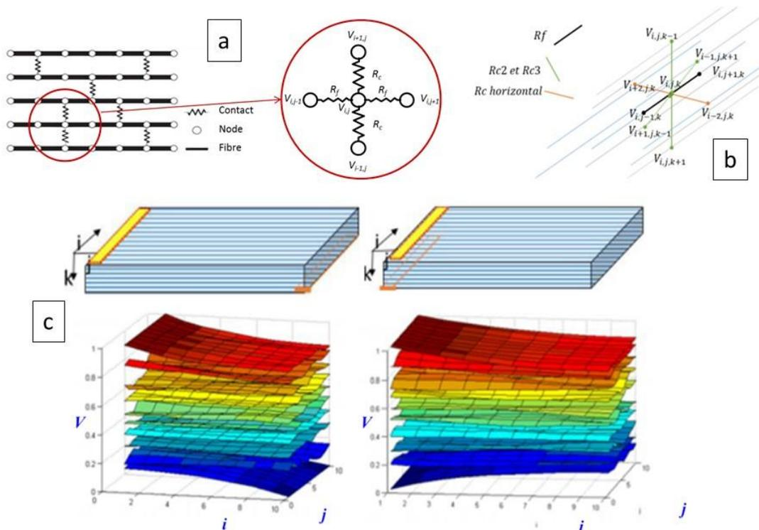
Fig. 8. Modélisation de la circulation de courant dans un stratifié  $[0^\circ_s]$ . a), schématisation 2D avec les contacts entre les fibres de carbone, b) schématisation 3D avec les contacts possibles entre les fibres qui peuvent être horizontaux, verticaux et en diagonale, c) répartition de la tension électrique (V en volts – tension appliquée = 1V) dans l'épaisseur un stratifié  $[0^\circ_s]$  pli par pli en fonction de la position des électrodes d'amenée et de sortie du courant [5].
