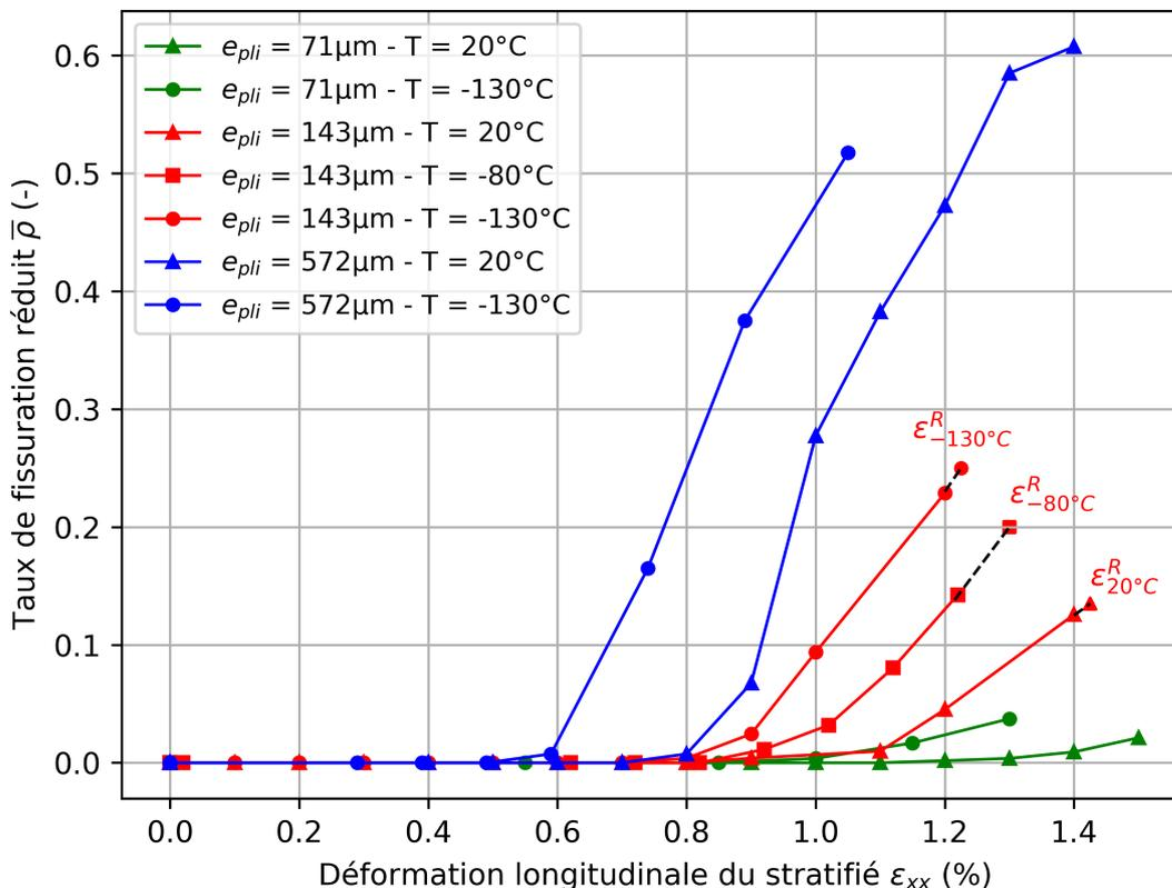
Fig. 4. Influence de la température sur le taux de fissuration réduit sur le pli simple d'épaisseur  $143\mu\text{m}$  d'un stratifié  $[0/90/0/90_2]_s$
