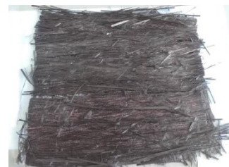
Fig.3b. Préforme « UD » réalisée par assemblage de bandes
