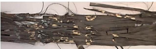
Fig. 3a. Bande continue de fibres réalignées discontinues
