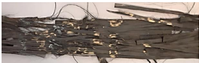
Fig. 3a. Bande continue de fibres réalignées discontinues
