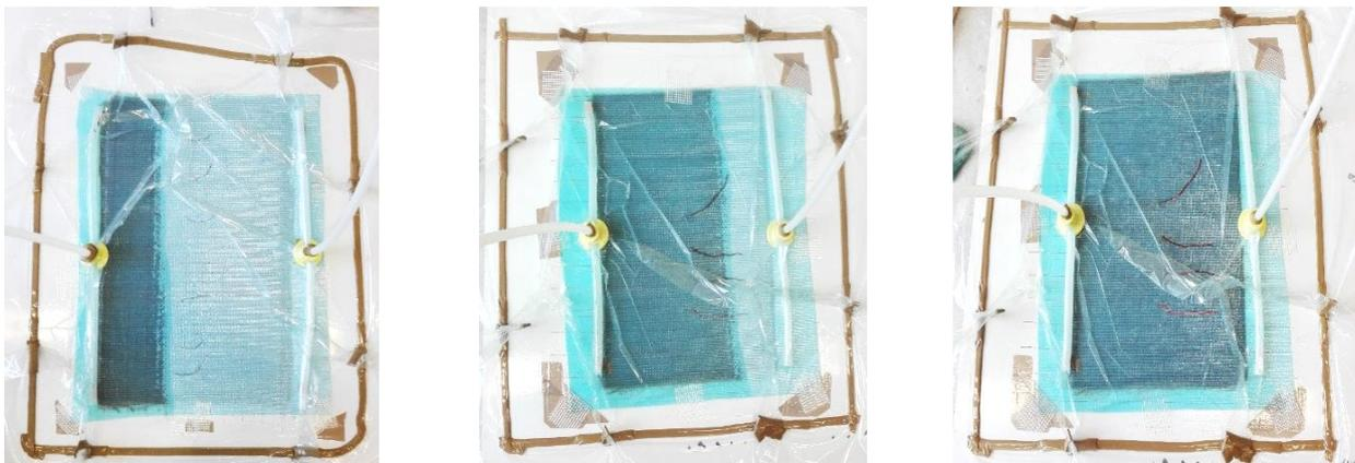
fig. 2. Différentes phases d'infusion
