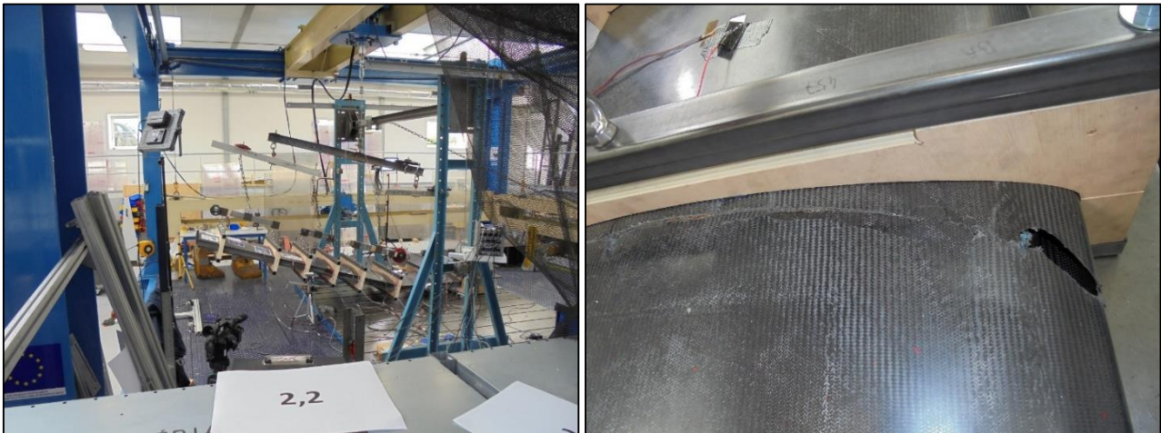
Fig. 10. Rupture de l'aile à 13.2G
