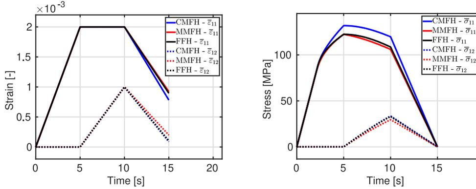
(a) Déformation appliquée ( $\bar{\epsilon}_{11}$  et  $2\bar{\epsilon}_{12}$ ) vs (b) Réponse en contrainte ( $\bar{\sigma}_{11}$  et  $\bar{\sigma}_{12}$ ) vs temps temps
