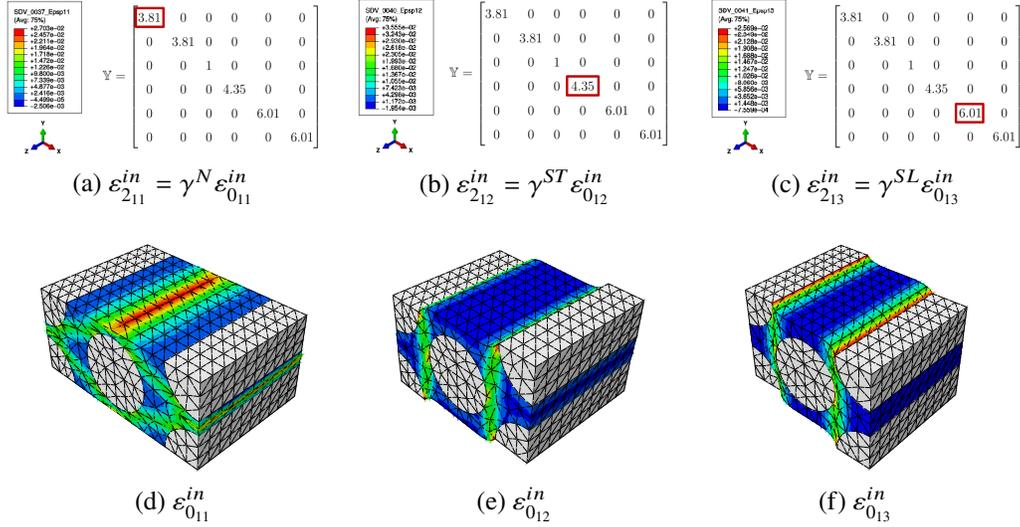
Figure 2: Comparaison entre la taille de la zone de concentration de la déformation inélastique dans la matrice  $\varepsilon_0^{in}$  et la valeur de chaque composante du tenseur de correction  $\mathbb{Y}$ , pour un composite élastoplastique renforcé par 50% de fibres longues dirigées dans la direction z, pour trois chargements différents: traction transversale (2d), cisaillement dans le plan (2e) et cisaillement hors du plan (2f).
