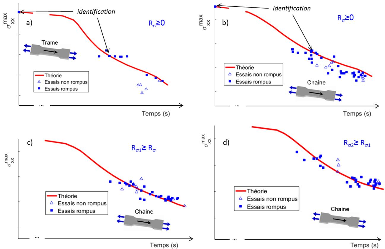
Fig. 5. Comparaison des courbes S-N prévus et mesurés pour des essais de fatigue à 5Hz en traction sens trame avec  $R_\sigma=0.05$  (a) et sens chaine (b-d) avec trois différents rapports de charge ( $0 \leq R_\sigma \leq R_{\sigma 1} \leq R_{\sigma 2} \leq 1$ ).
