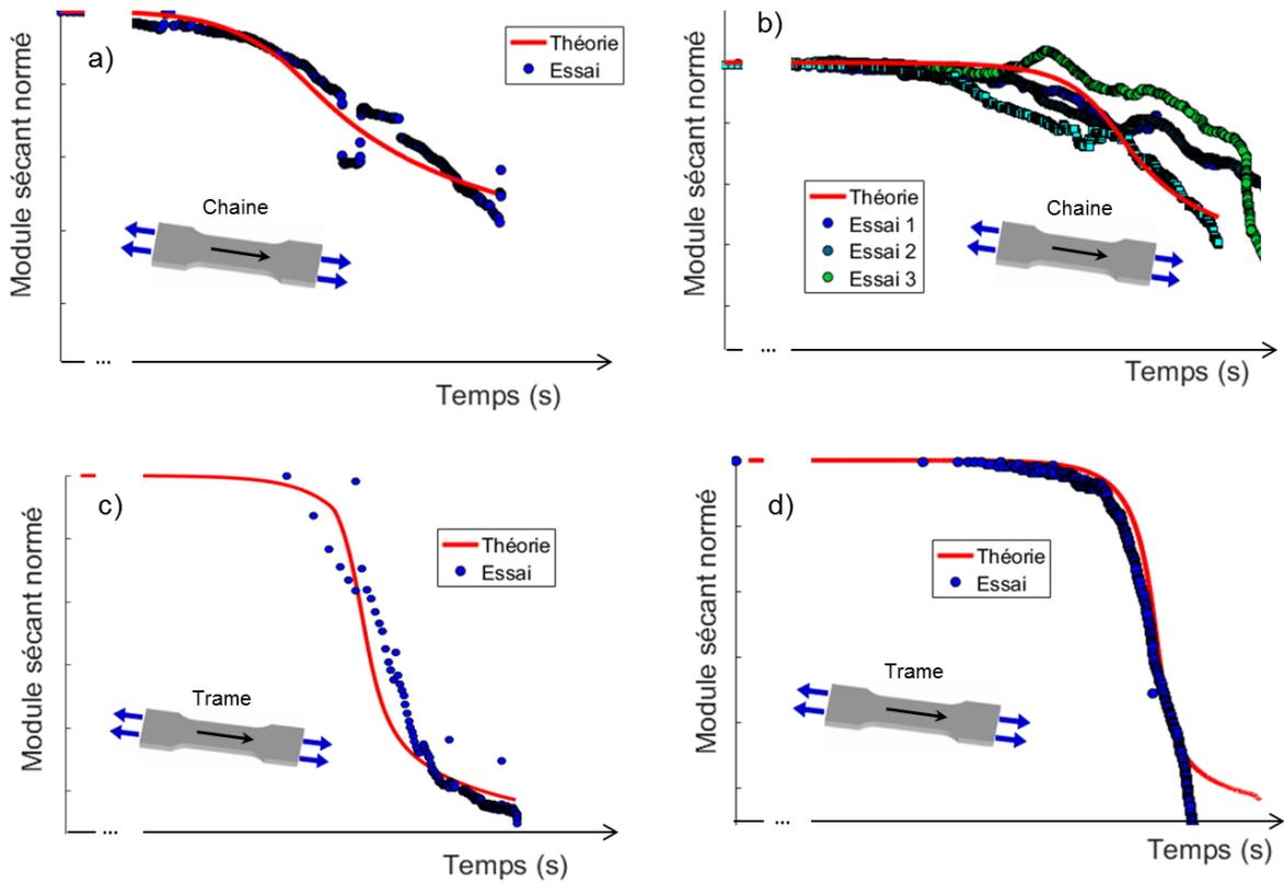
Fig. 4. Comparaison des évolutions des modules sécants prévus et mesurés pour des essais de fatigue à 5Hz et  $R_\sigma=0.05$  en traction sens chaine (a) à 65% et (b) à 45% de  $\sigma_R$  et sens trame (c) à 55% et (d) à 28% de  $\sigma_R$
