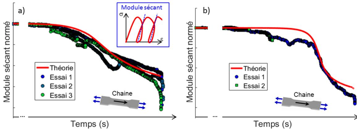
Fig. 3. Comparaison des évolutions des modules sécants prévus et mesurés pour des essais de fatigue à 5Hz avec  $R_{\sigma}=0.05$  en traction sens chaîne (a) à 60% et (b) à 38% de la résistance statique  $\sigma_R$ .
