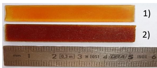
Figure 3 : Epreuves de polyépoxyde 1) DGEBA/AC 2) EpoxyBio/AC
