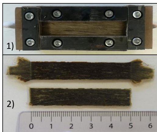
Figure 4 : Préparation des éprouvettes de composite 1) Moule avec mèches de chanvre alignées et fixées 2) Eprouvettes de composites
