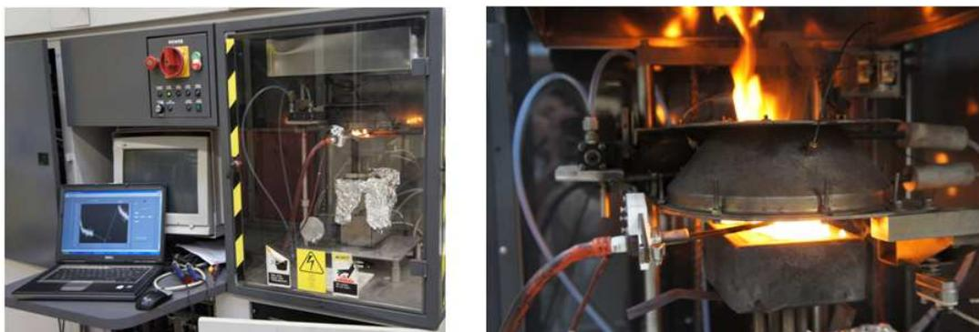
Fig. 1. Le cône calorimètre ATLAS Cone2 et détail d'un échantillon de matériau composite sandwich en cours de combustion.
