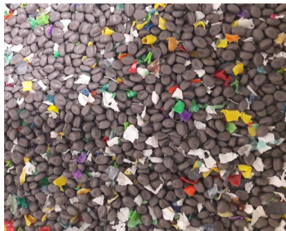
Figure 1. Echantillons de polymères recyclés avant extrusion pour le mélange PP 80 m% et PET opaque 20m%
