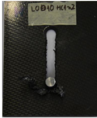
Fig. 4. Eprouvette après test (statique, diamètre 10, chanfrein simple)
