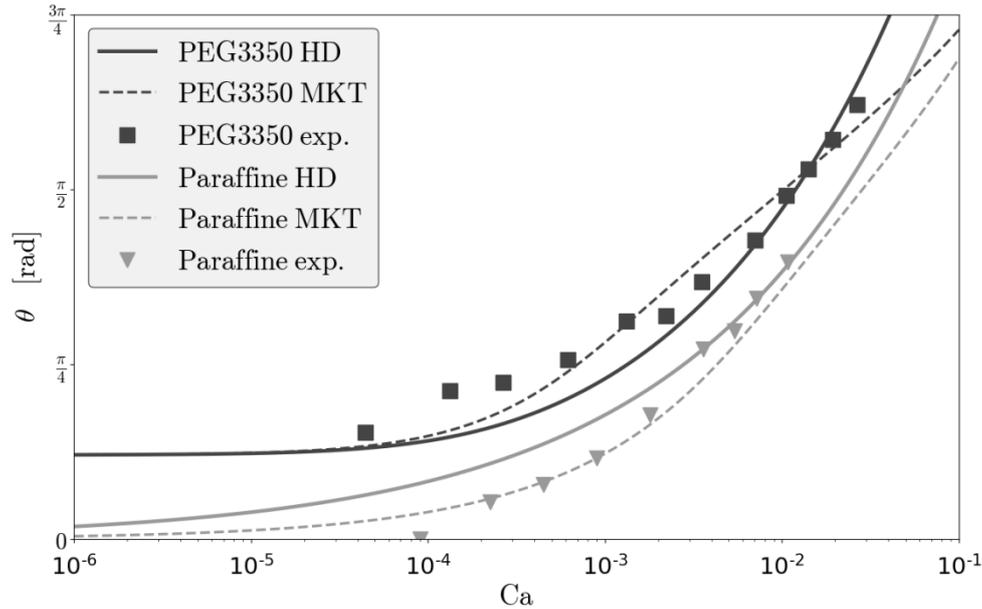
Fig. 3. Dynamique de l'angle de contact de deux liquides sur un substrat cellulosique pour les modèles HD et MKT.
