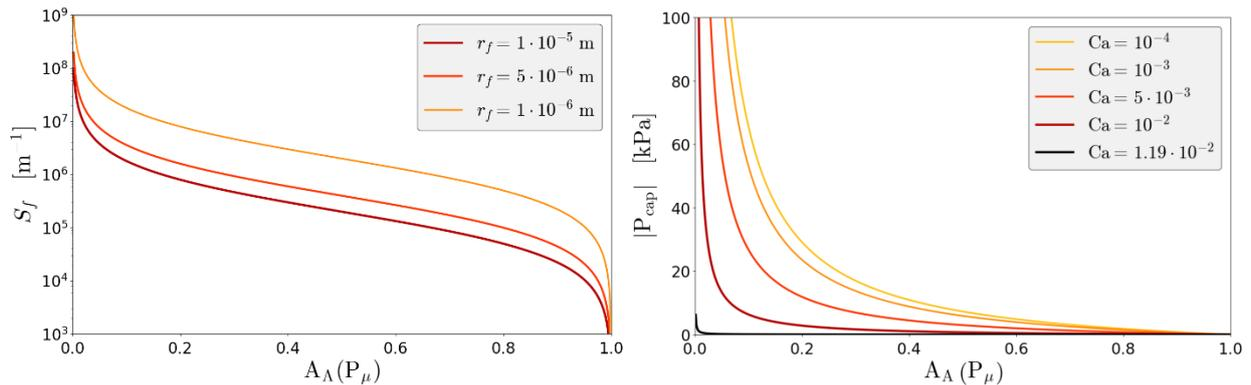
Fig. 4. Surface spécifique et pression capillaire d'un PEG 3350 dans une mèche en fonction de son taux de pores.
