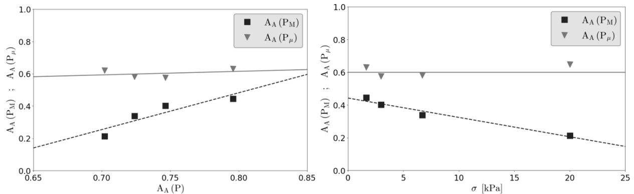
Fig. 8. Répartition des micropores et des macropores en fonction de la porosité et de la contrainte imposée.
