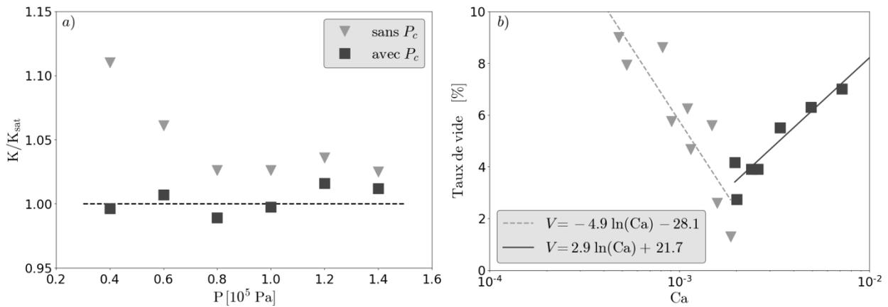
Fig. 1. (a) mesures du rapport entre la perméabilité insaturée et la perméabilité saturée dans une préforme de verre cousu ( $V_f = 50\%$ ), avant et après prise en compte de la pression capillaire  $P_c$ . (b) mesures du taux de vides et compétition visco-capillaire pour une huile silicone – données issues de [10].
