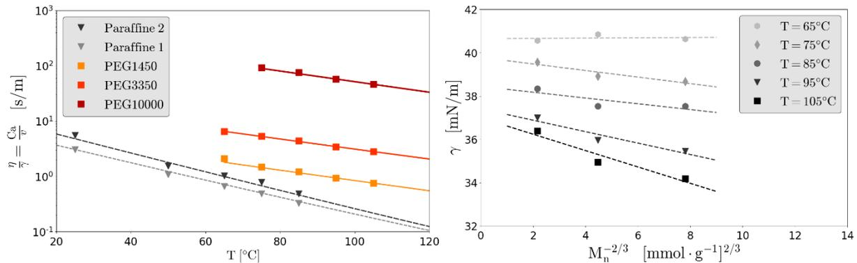
Fig. 2. Rapport des viscosités et des tensions de surface en température des liquides modèles de référence (gauche). Evolution des tensions de surface des PEG suivant la loi empirique de Le Grand et Gaines (droite).
