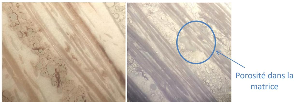
Fig. 3. Vue microscopique de l'échantillon Lin/PA11
