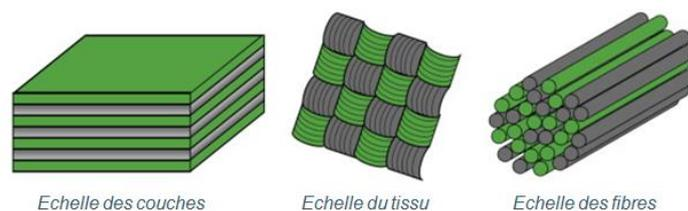
Fig.5. Les différentes échelles d'hybridation des matériaux composites [1]
