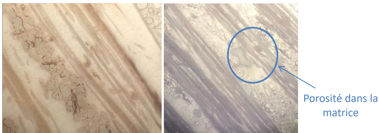
Fig. 3. Vue microscopique de l'échantillon Lin/PA11
