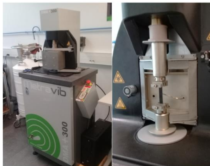
Fig. 4. Machine DMA Metravib et montage de l'éprouvette
