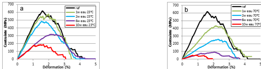
Fig. 4 : Courbes de comportement en tension des mèches de lin (longueur de jauge l_0 = 20 mm) en fonction du temps de vieillissement en immersion dans l'eau à 23°C (a) ; 70°C (b).
