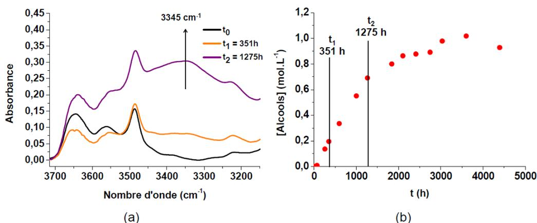
Fig. 1. a) Modification de la région des hydroxyles du spectre IRTF et b) Evolution de la concentration des alcools au cours du vieillissement thermique du PEI dans l'air à  $250^\circ\text{C}$ .
