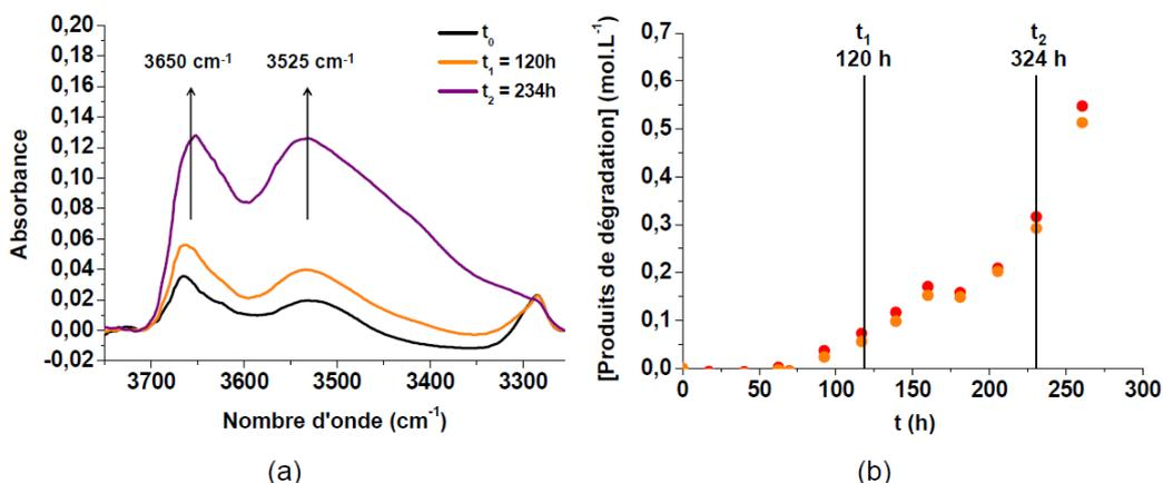
Fig. 2. a) Modification de la région des hydroxyles du spectre IRTF et b) Evolutions des concentrations des phénols (en rouge) et des acides benzoïques (orange) au cours du vieillissement thermique du PEEK dans l'air à  $320^\circ\text{C}$ .
