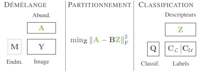
FIGURE 1 – Modèle de cofactorisation. Bleu : observations ou données annexes, vert : variables couplées, en pointillé : variable supposée connue.
