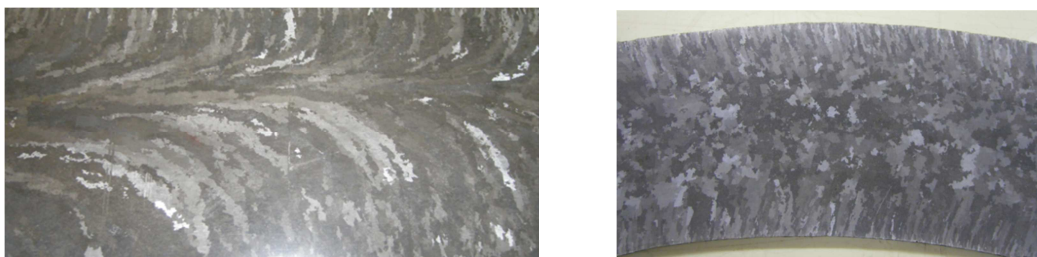
Figure 2 : Exemples de textures d'acier inoxydable austénitique (centrifugé, moulé statique) photos EDF
