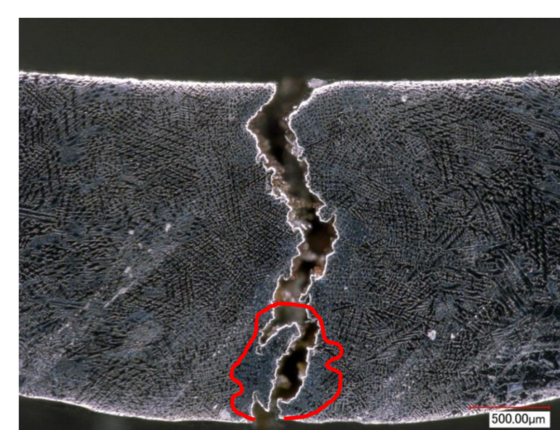
(a) : croissance en épitaxie des grains près de la ligne de fusion (b) : croissance compétitive entre grains dans la zone de fusion
