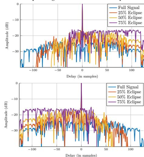
Figure 7 – Optimisation pour des éclipses gauche et droite
