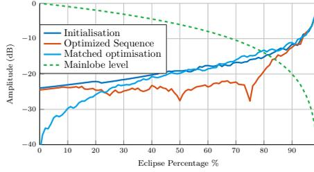
FIGURE 4 – PSLR selon le coefficient d'éclipse
