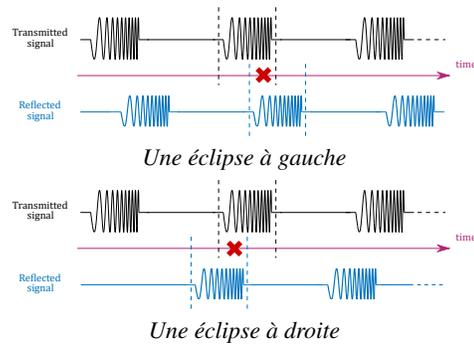
Figure 5 – Différents types d'éclipse
