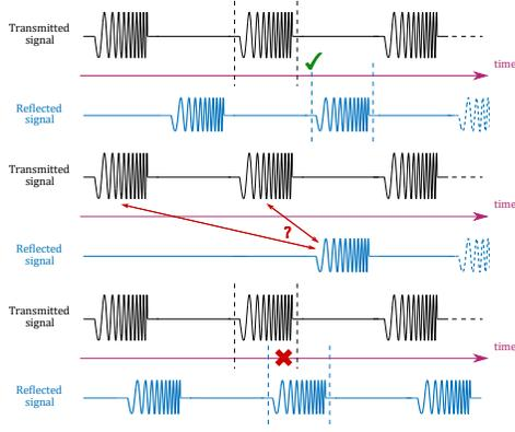
FIGURE 1 – Illustration d'un phénomène d'éclipse
