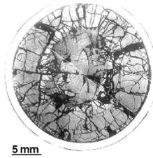
Coupe d'un crayon absorbant irradié dans le réacteur Phénix [3]
