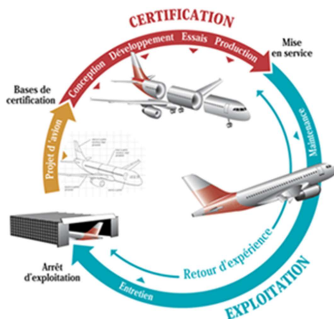
Figure 5 – Certification d'un aéronef
