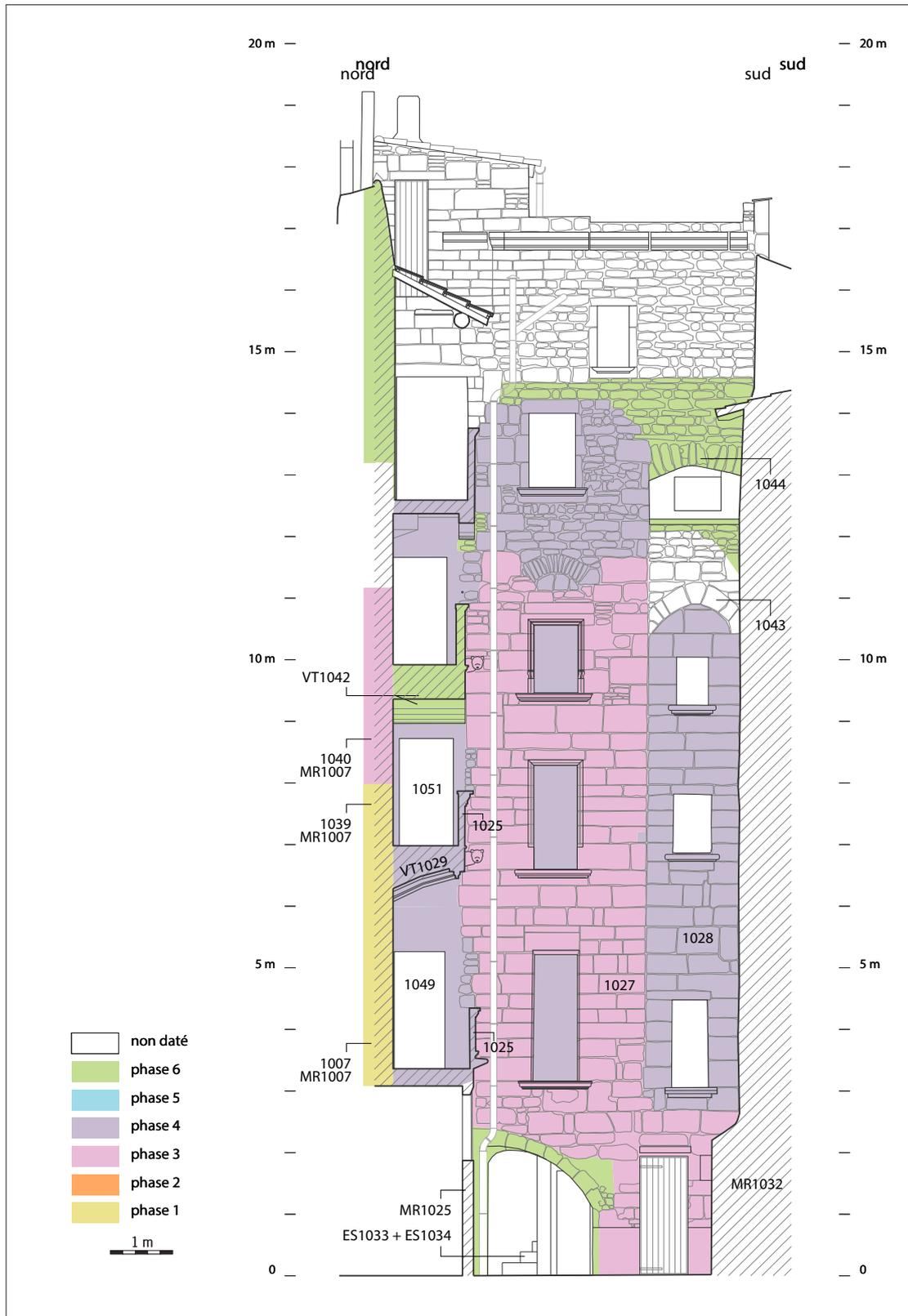
**Fig. 28** Section nord-sud de la cour avec la façade méridionale MR1007 doublée des loggias en coupe et l'élévation du mur MR1025 de l'escalier en vis. Étapes de construction reconnues. Fond de plan : SARL NDA.
