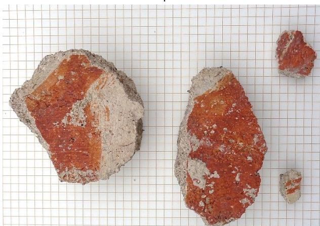
Fig. Fragments d'enduits à peinture orangée, présents dans les Us 6120 et 6115-6119. Ce style de peinture est inconnu dans les enduits des Us plus récentes. Un fragment comparable posé sur un morceau de tuf a été retrouvé entre le M61 et le M61a, sans pouvoir définir s'il appartenait à la semelle de fondation du M61 ou au M61a. Les carreaux mesurent 0,5 cm de côté. Crédit Florence Guillot
