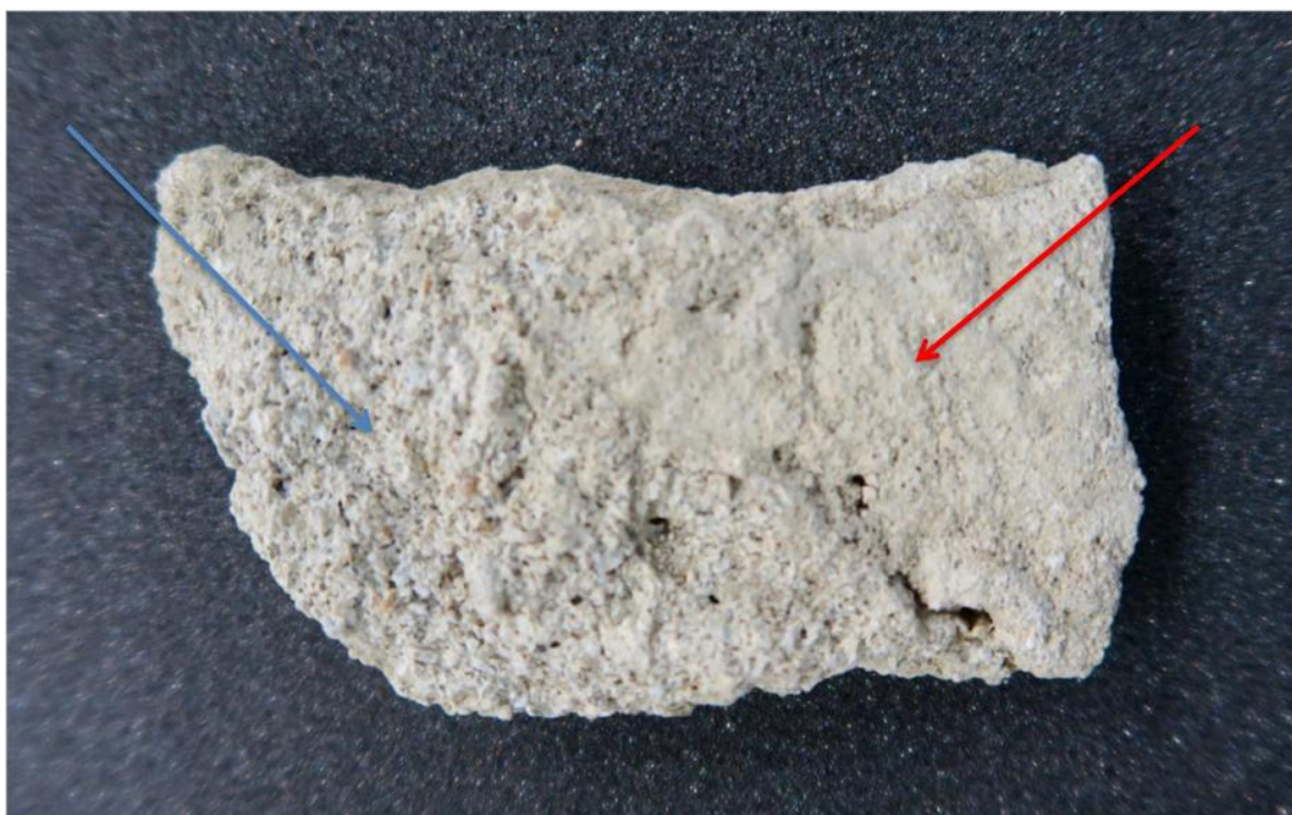
En bleu un enduit grossier et en rouge un enduit fin. Ces 2 types d'enduits indiquent des reprises ou des restaurations à 2 époques différentes
