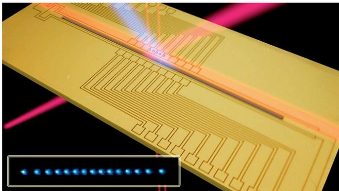
Image d'ions calcium en ligne, refroidis et contrôlés dans un piège électromagnétique (on parle de piège de Paul). Au sein du piège, deux ions voisins sont séparés par 10-20  $\mu\text{m}$ . Le piège est réalisé sur puce électronique où des fils parcourus par des courants réalisent les champs électriques et magnétiques nécessaires au piégeage. Le système sert pour la simulation et le calcul quantiques (*courtoisie Rainer Blatt, IQOQI, Innsbruck*).
